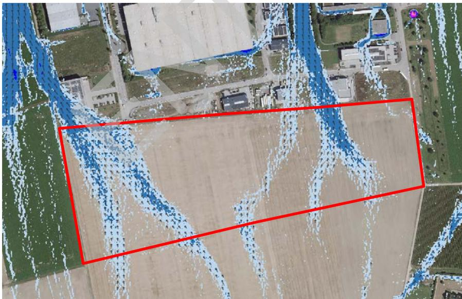
Ausschnitt aus der Sturzflutgefahrenkarte, außergewöhnliches Starkregenereignis (SRI7) mit einer Regenmenge von ca. 40 – 47 mm in einer Stunde (entspricht etwa einem 100-jährigen Niederschlagsereignis); Plangebiet rot markiert
