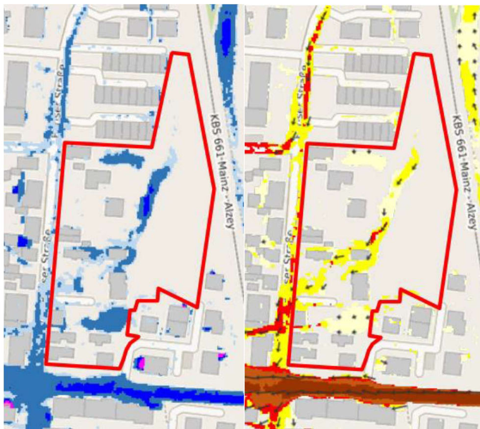
Sturzflutgefahrenkarte Wassertiefen, Fließgeschwindigkeit, Fließrichtung für SRI 7, 1 Std.
