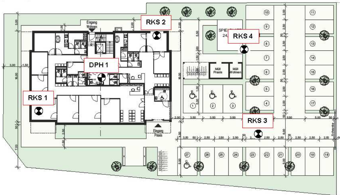
Übersichtsplan mit Kennzeichnung der Lage der Bohrpunkte (unmaßstäblich), Quelle: Baugrundinstitut Dr.-Ing. Westhaus GmbH: Gutachterliche Stellungnahme..., Anlage 1
